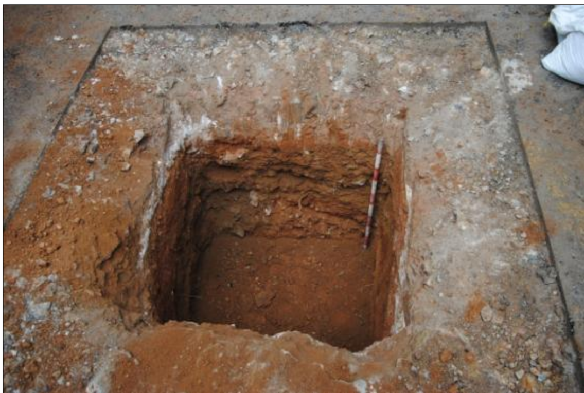
Figura 46. Cala 4. Argiles amb una franja de formigó al mig molt descompost.
